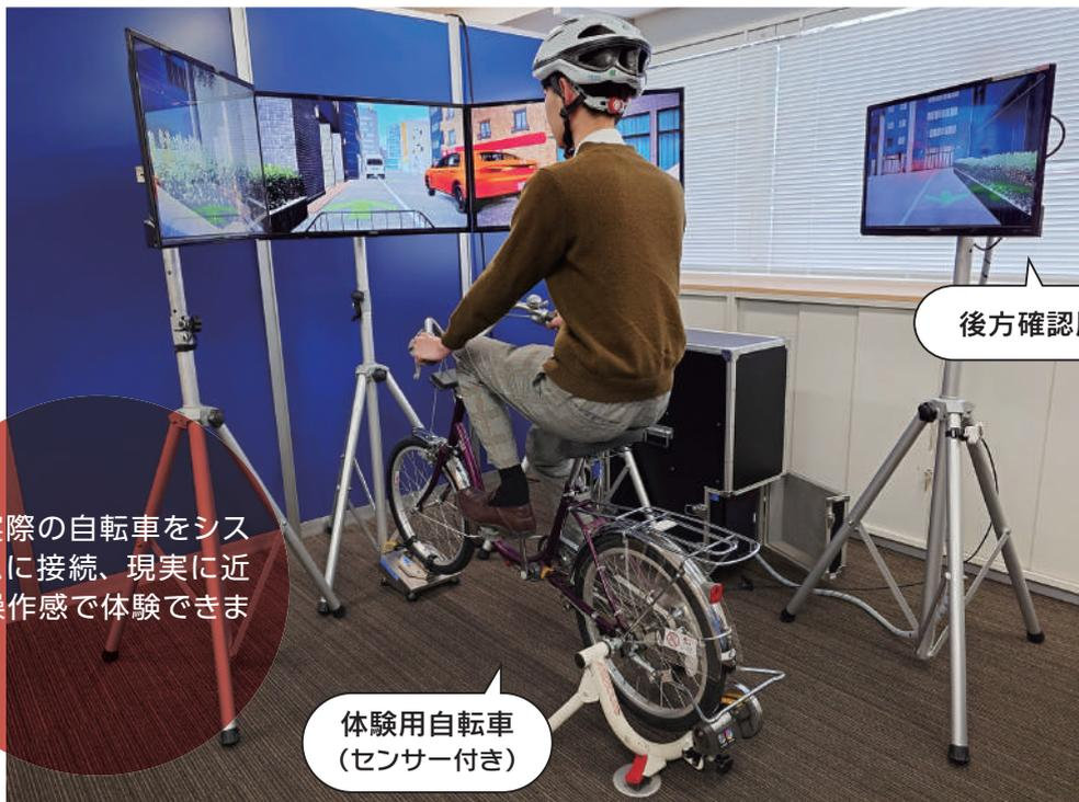
実際の自転車をシステムに接続、現実に近い操作感で体験できます。
