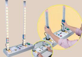
落ちてくる光をつかんで俊敏性を測定。左右の手の反応速度差を知ることで、両手でのハンドル操作の重要性を啓発。認知力・判断力の自覚を促し、安全行動を啓発。
