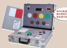
ランプ点灯後に同色のマットを踏むまでの時間を測り、俊敏性を計測。目と足を使った動作検証で加齢に伴う能力低下の自覚を促し、安全行動を啓発。
